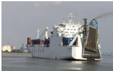
Rosa Delmas (1985), Porte-conteneurs-roulier. Port : 24 600 t. Capacité 1183 conteneurs équivalents 20 pieds. Hangar de 3300 m pour véhicules, accessible par passerelle arrière.
