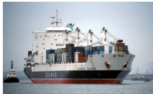
Le Thérèse Delmas Construit en 1983. Porte conteneur intégral de 32 000 t de port et de 1600 conteneurs standard (20 pieds) de capacité.
