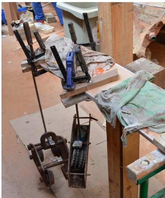
Figure III – Galbord mis sous tension pour être déformé à l'aide de poids suspendus et grâce à l'apport d'humidité par les linges mouillés. Ici, le galbord est vrillé dans le mauvais sens.
