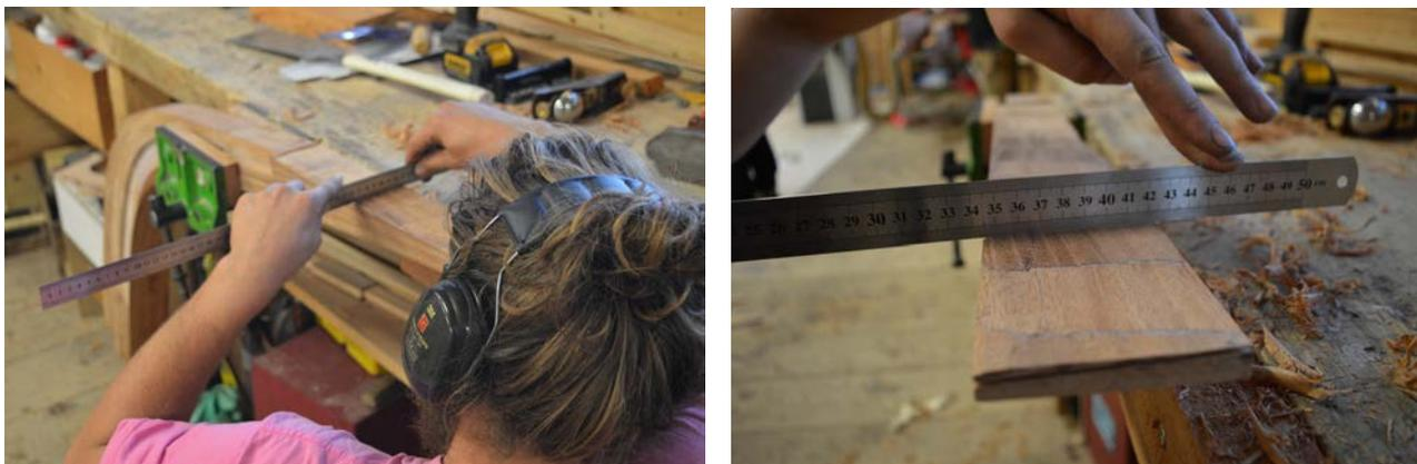
Figure XXI – Un élève de *Skol ar Mor* en train de façonner l'étrave d'un bateau. Le réglet sert à vérifier la rectitude de la surface.
