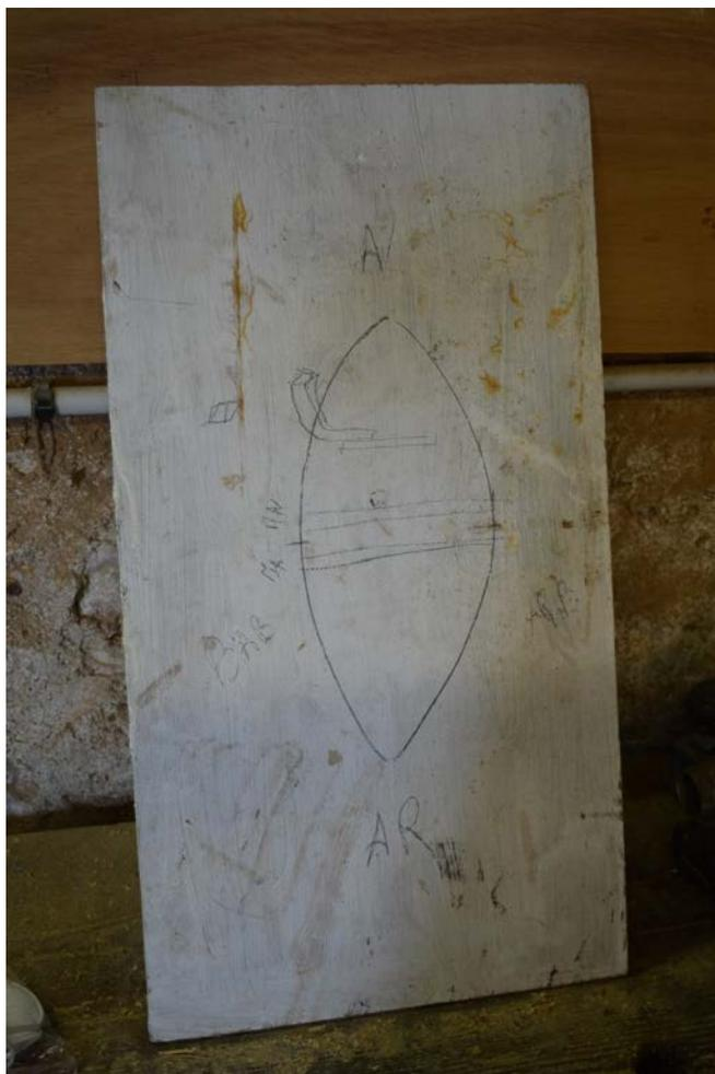
Figure II – Dessin fait par Yann Pajot sur un morceau de contre-plaqué pour figurer *L'Espérance* et notamment la manière dont les angles entre les membrures et la coque se ferment vers l'avant et vers l'arrière.
