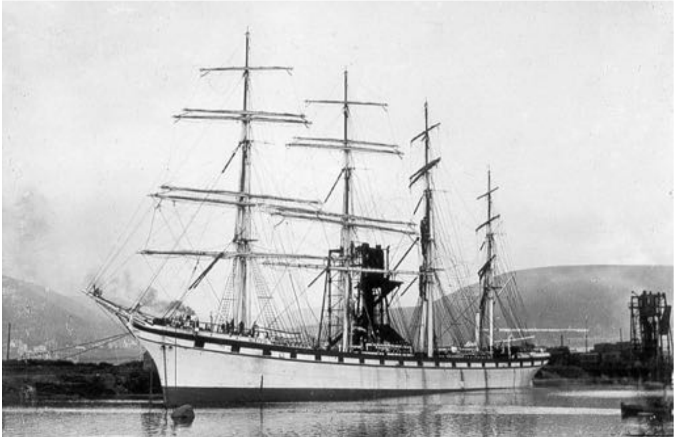
Le quatre-mâts Union à quai, "sous le spout", charge du charbon déversé en vrac dans sa cale par les panneaux grands ouverts. Coll. Bordes.
