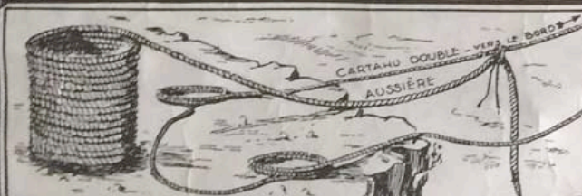
2 A terre, les sauveteurs amarront le bout de l'aussière sur l'un des doubles du cartahu. Ils hâlent sur l'autre double du cartahu pour envoyer l'aussière à bord.
