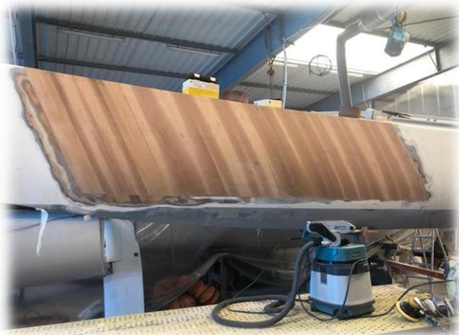
complet du système de gouvernail, l'arrière a été coupé pour installer un tube de jaumière et un safran suspendu semblable à celui d'Acapella, l'arrière canoë a été reconstruit dans l'esprit du 50' Lucky Strike. Carène et dérive ont également été peaufinées. Un hublot rond a été posé à l'arrière pour augmenter la lumière dans le carré. Côté gréement, le tube aluminium récent a été conservé avec un
