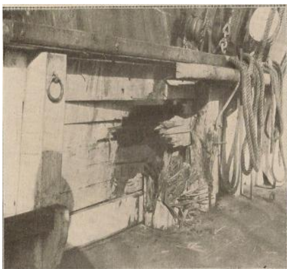
Les effets de deux coups de canon de 105 du sous-marin allemand U-7 contre le voilier Kléber : un dans le bastingage de bâbord, un dans le bastingage de tribord.
