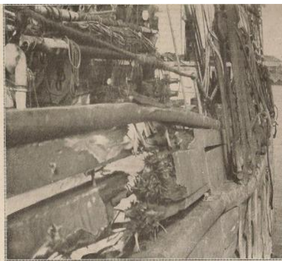
Les effets de deux coups de canon de 105 du sous-marin allemand U-7 contre le voilier Kléber : un dans le bastingage de bâbord, un dans le bastingage de tribord.
